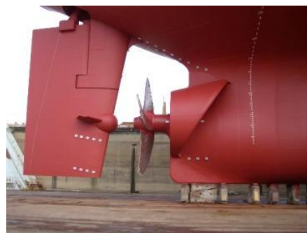
図 1.19 サーフバルブ（SURF-BULB） （ジャパン マリンユナイテッド株式会社提供）
